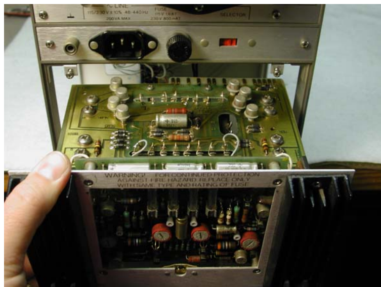
Abbildung 10: Netzteil wird wieder eingebaut
