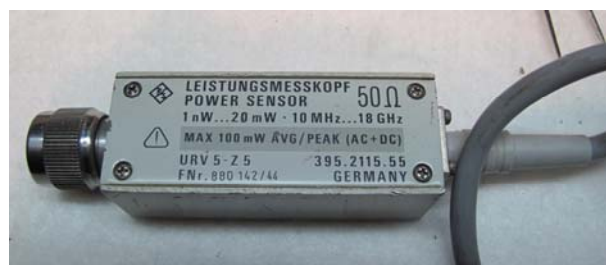
Abbildung 7: URV 5-Z5 wartet auch auf Reparatur
