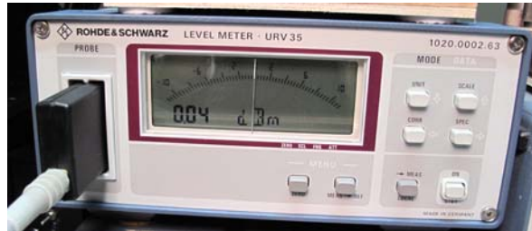
Abbildung 8: Test des reparierten URV5-Z5 Messkopfes
