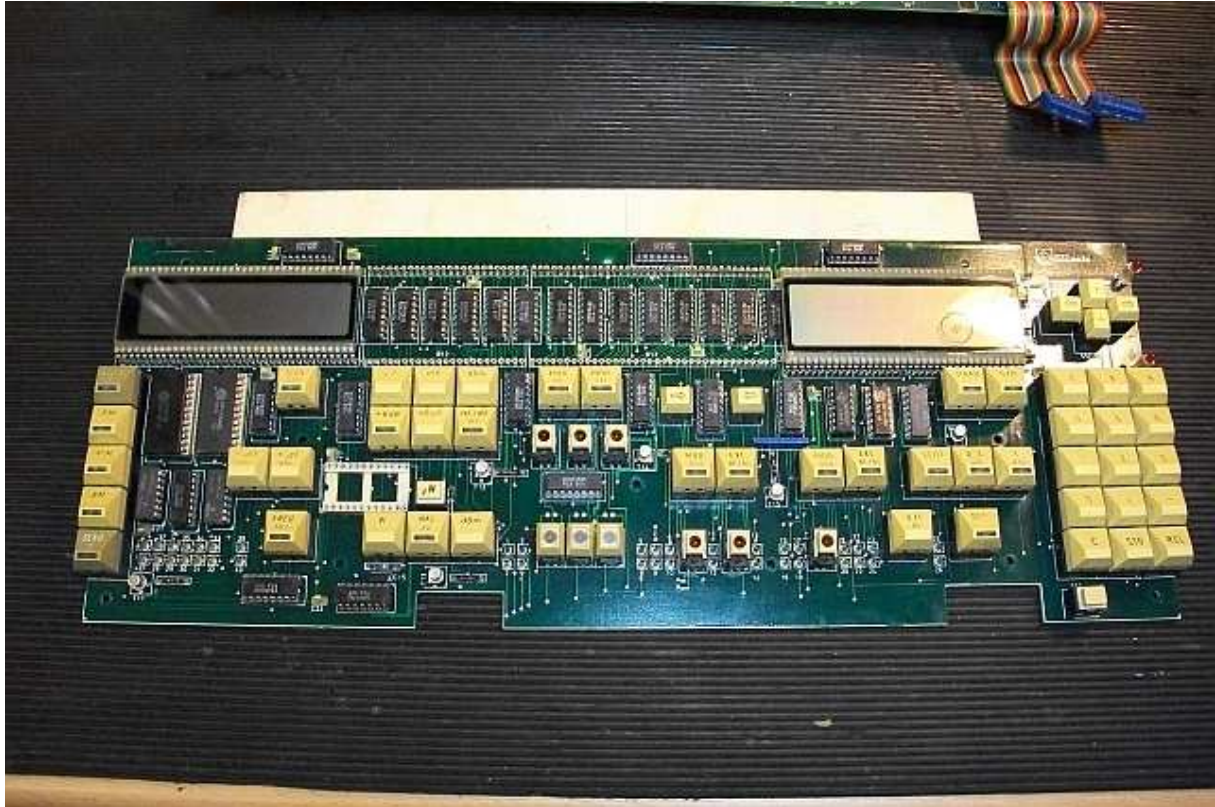
Abb. 5 Frontplatine defekte LCD bereits ausgebaut
