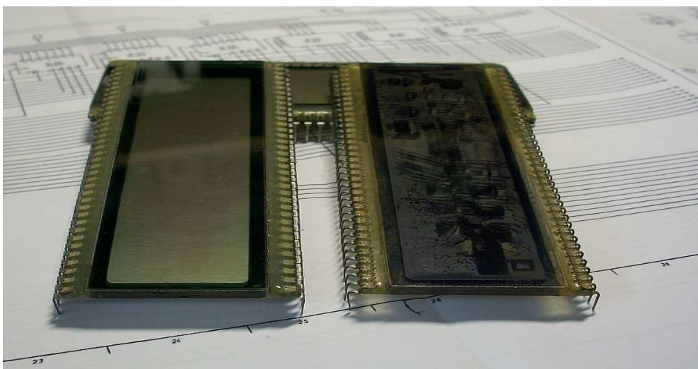
Abb. 7 Links gute Versiegelung, rechts defektes LCD Herstellung 9/80
