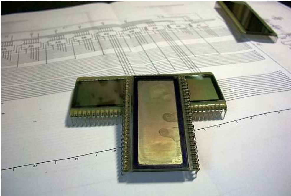
Abb. 8 Level Display, fast keine Versiegelung zu sehen
